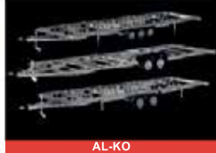
AL-KO Tiny-House - Chassis Ladelängen von 5,40 m bis 8,40 m - Tandem- oder Tridem-Achser - Hoch- oder Tieflader - ab 5.600,- €
